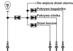
Rys. 4 Podłączenie przekaźników do sterowania fabrycznym zamkiem centralnym pneumatycznym sterowanym jednym przewodem
