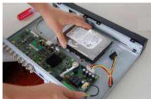
4) Umieść dysk na podstawie rejestratora wsuwając łby wkrętów w odpowiednie otwory montażowe.
