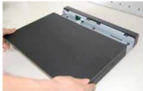
2) Odsuń do tyłu górną pokrywę rejestratora
