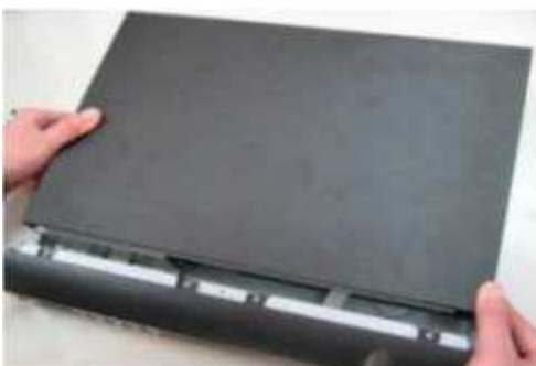
7) Załóż i przykręć pokrywę górną rejestratora.
