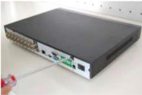
1) Odkręć górną pokrywę rejestratora
