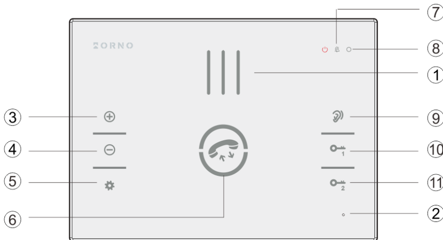
Abb. 1 Aufbau der Innenstation
